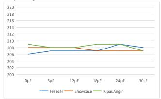
Gambar 9. Variasi kapasitor terhadap tegangan
