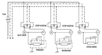
Gambar 6. Pemasangan kapasitor daya pada freezer, showcase, dan kipas angin
